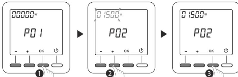
① Wählen Sie das Heizelement aus, indem Sie mehrfaches drücken OK.
