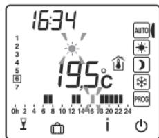
Im Automatikbetrieb wird das aktuelle Aufheizprogramm durch das blinkende Symbol
