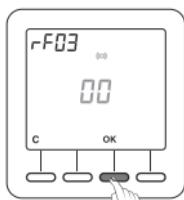
Springt die Anzeige nicht wieder auf 00 zurück, bedeutet dies, dass einige Empfänger nicht auf Befehle reagieren.
